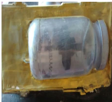
Figura 1- Recipiente de vidro simulando a ampola de Raios X à vácuo em torno do óleo.
