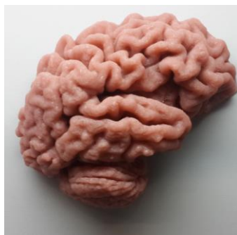
Figura 1- Hemisfério cerebral direito, feito a partir de gel de SEBS para treinamento de procedimentos de neurocirurgia.
