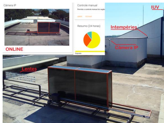
Figura 1 – Sistema automático de exposição, com sensores de intempéries e IUV, lentes e o sistema monitoramento remoto.
